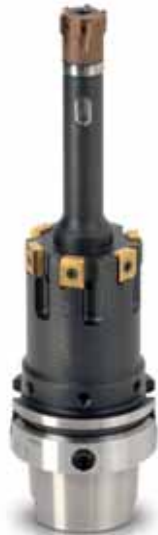
DIHART® Sonderwerkzeug 2-Stufen-Reibahle auf HSK 63 1. Stufe modular und nachstellbar TiN-beschichtet für Ø 20 H7, 2. Stufe fest und modular DBF- beschichtet für Ø 50H7.
